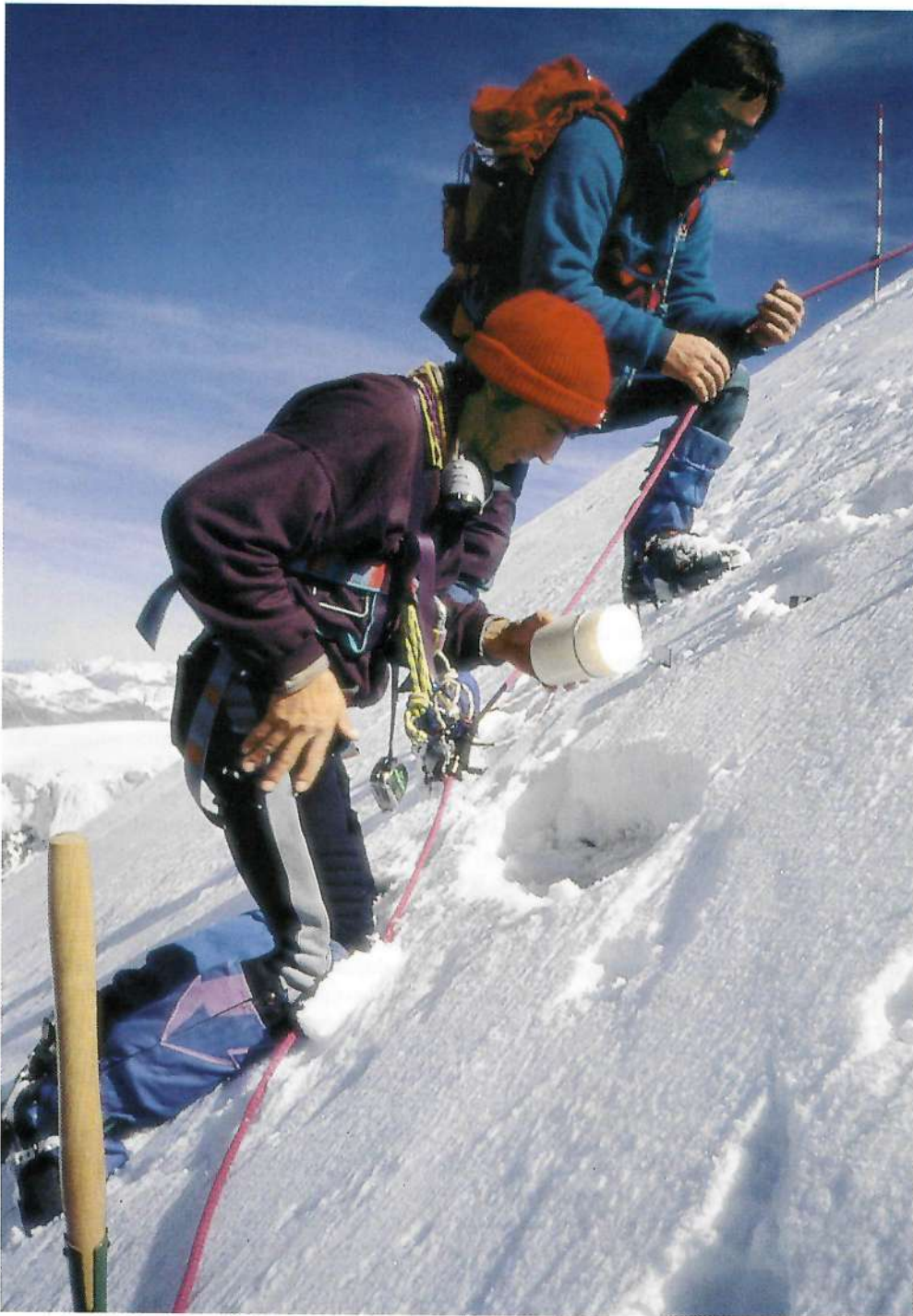
Il controllo della densità dell'accumulo nevoso nel settore più elevato della parete. Foto V. Paneri., 8.10.1995
